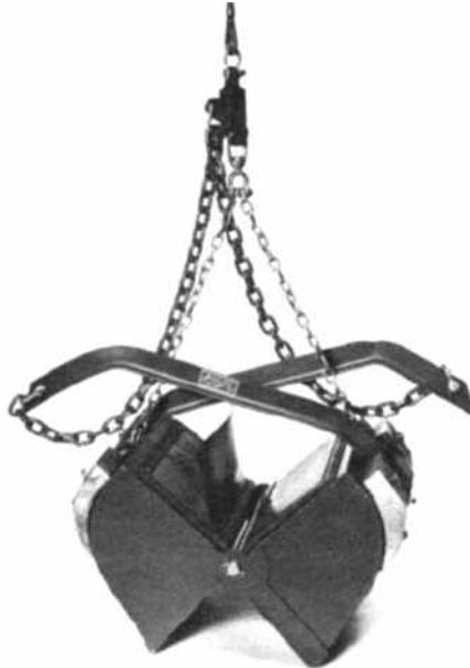
La benne Van Veen (poids à vide 20 kg)
