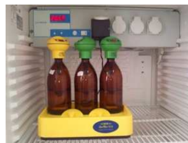
Figure 7: Dispositif pour la mesure de la DBO_5
