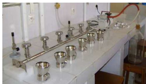
Figure11: Dispositif de l'appareil de filtration sur membrane.
