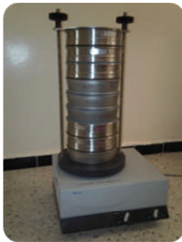
Figure 9: Le dispositif de tamisage des sédiments : Tamiseuse électrique.
