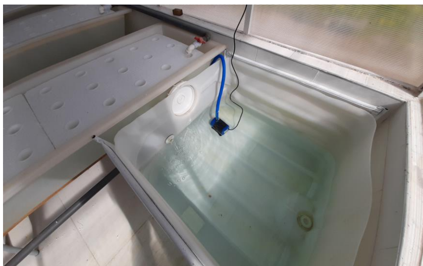
Figure 30 : tuyau souple attaché à une pompe submersible
