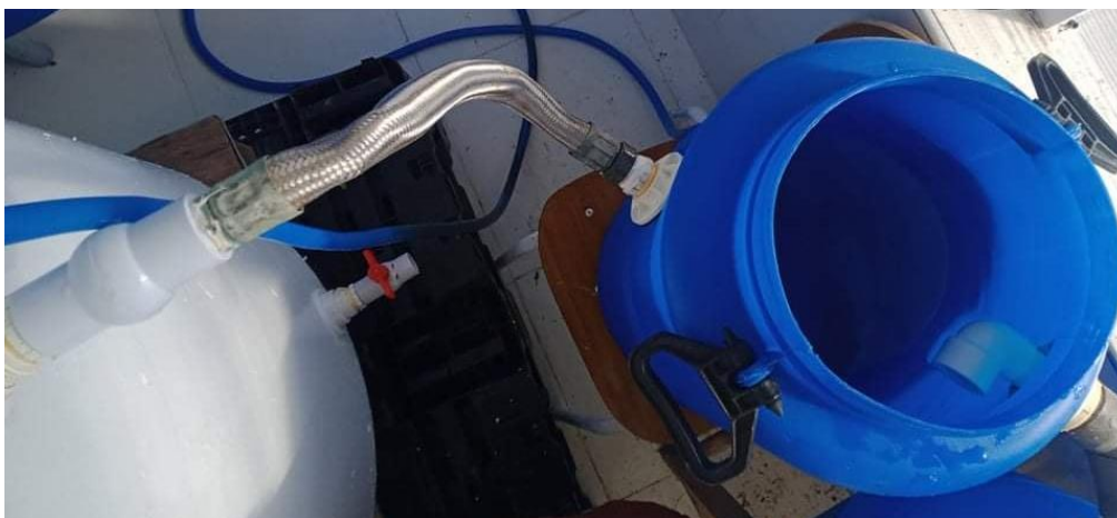
Figure 25 : L'emplacement de tuyaux flexible du bac de poisson vers le filtre à tourbillon
