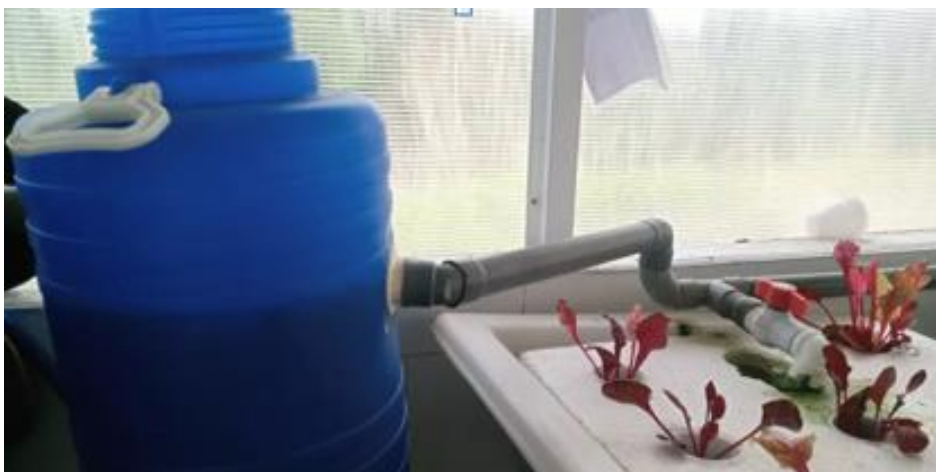
Figure 27 : La tuyauterie entre le bio filtre et les bacs de culture
