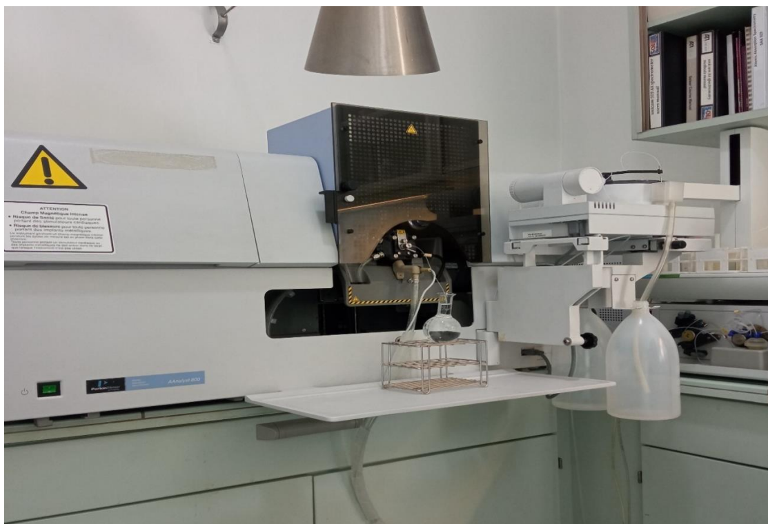
Figure 1 : Spectrophotomètre d’Absorption Atomique a four graphite de type Perkin Elmer Aanalyst 800.
