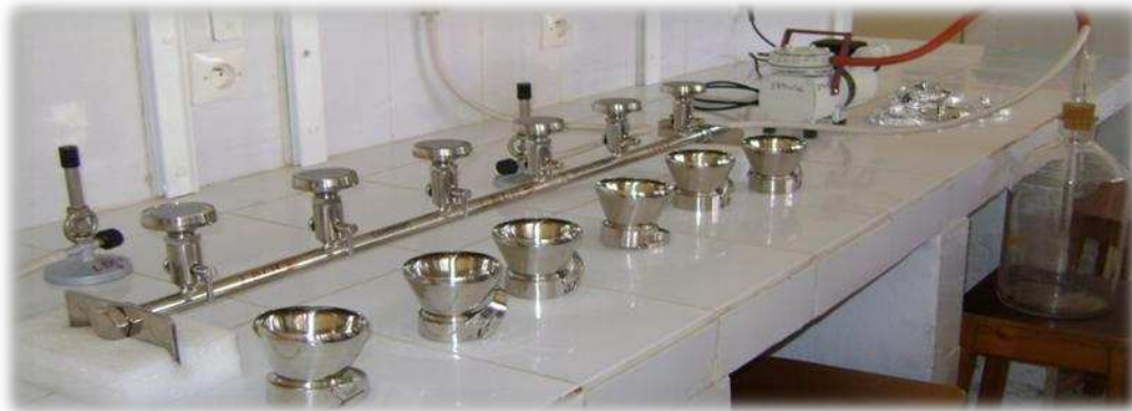
Figure 3.6 : Dispositif de l'appareil de filtration sur membrane.
