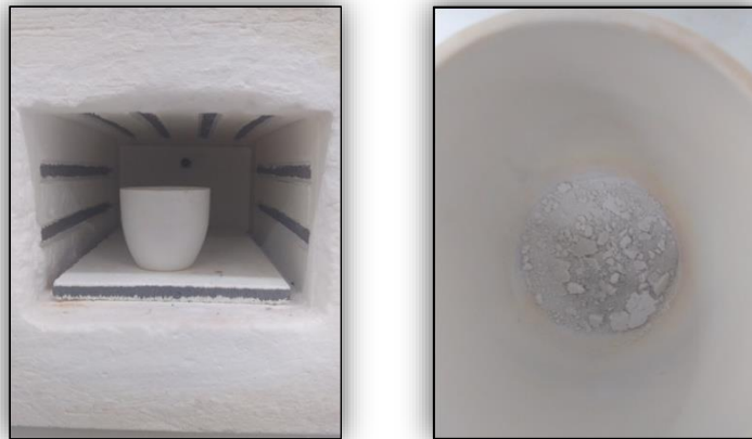
Figure II.6 : l'incinération de la poudre d'algue U.fasciata dans un four à moufle.
