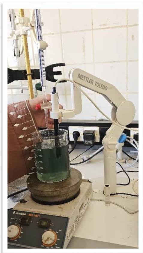
Figure II.43: ajustement du pH par NaOH
