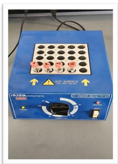
Figure II.27 : le réacteur COD préchauffé Figure II.28 : le spectrophotomètre
