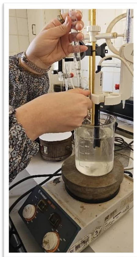
Figure II.44 : ajustement du pH par HCl
