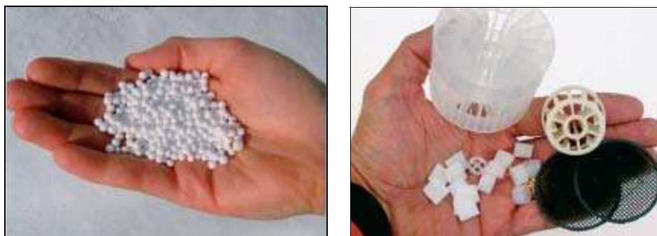
Figure 10: Billes de polystyrène expansé et éléments de plastique comme supports de biofilm utilisés dans les biofiltres (Joss et Maurer, 2006).
