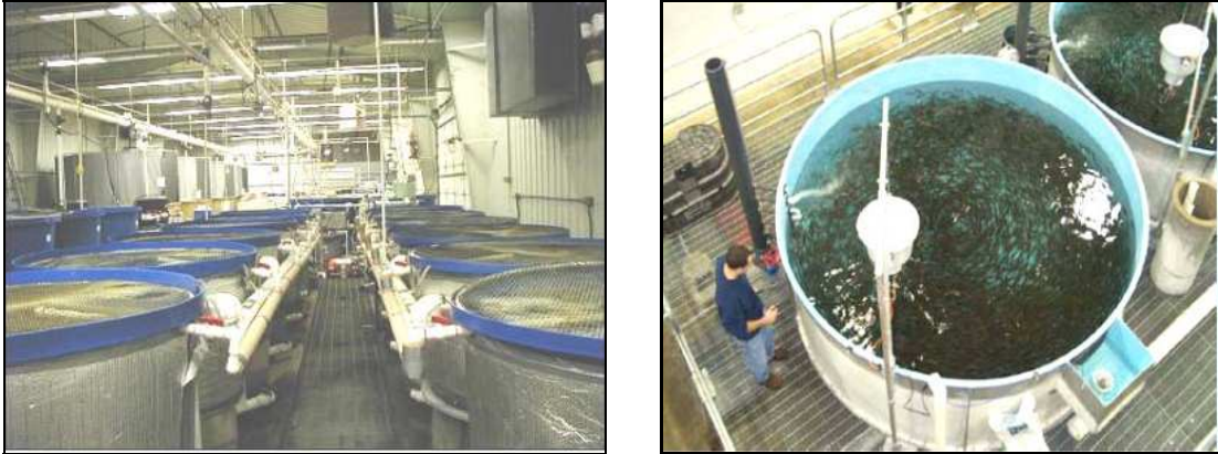
Figure 9 : A gauche une série de Biofiltres utilisés en pisciculture à droite un bassin d'élevage (www.dfo-mpo.gc.ca).
