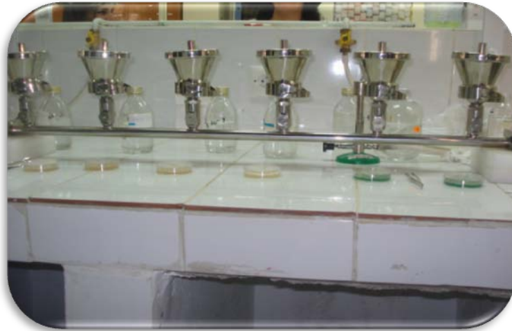
Figure (16): dispositif de filtration en inox à six poste de marque Sartorius
