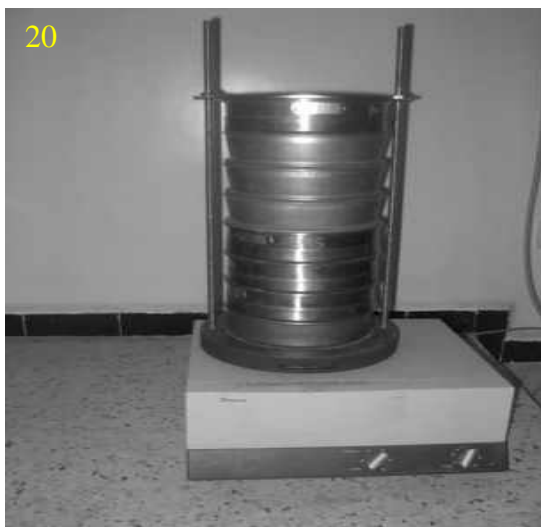
Figure 14. Méthodologie ; photo 20. Présentation de la série de tamis sur la plaque vibrante.
