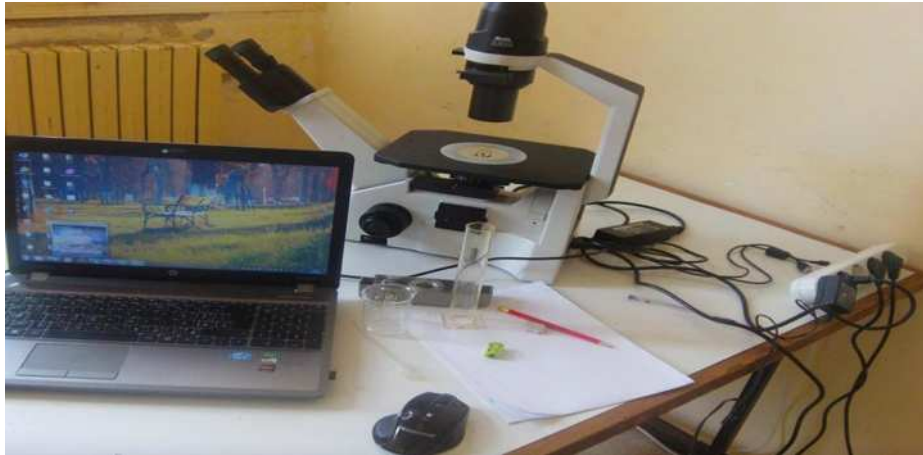
Figure 10 : Microscope photonique type OPTIKA B 500, avec caméra numérique MA88-300 placée .
