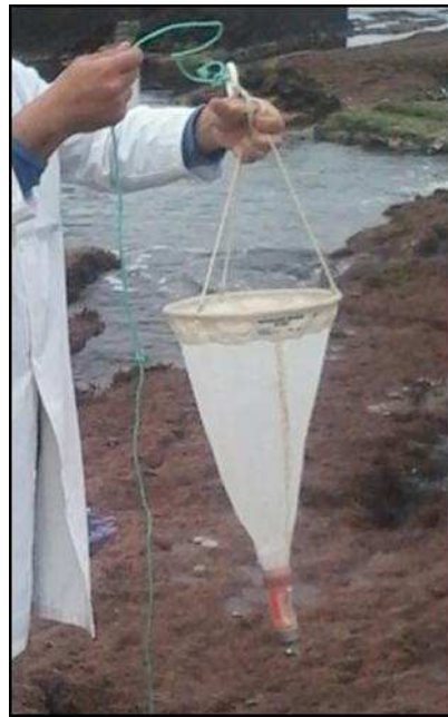
Figure 09 : Filet à plancton de marque « Hydro-Bio KIL »
