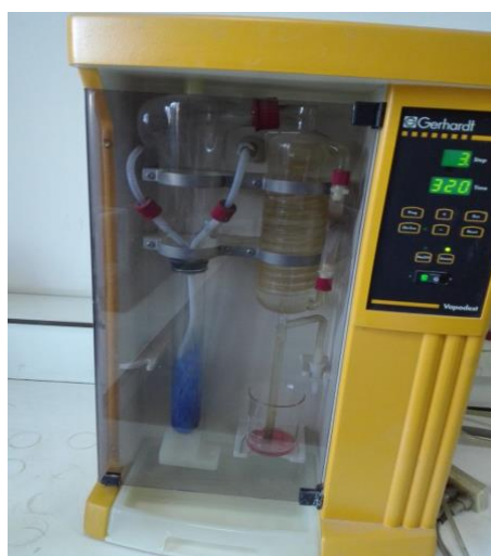
Figure 9: La distillation des échantillons.
