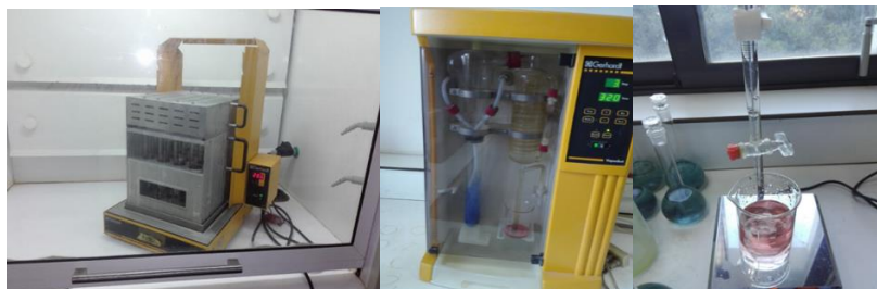
Figure 6 : les étapes de méthode Kjeldahl.
