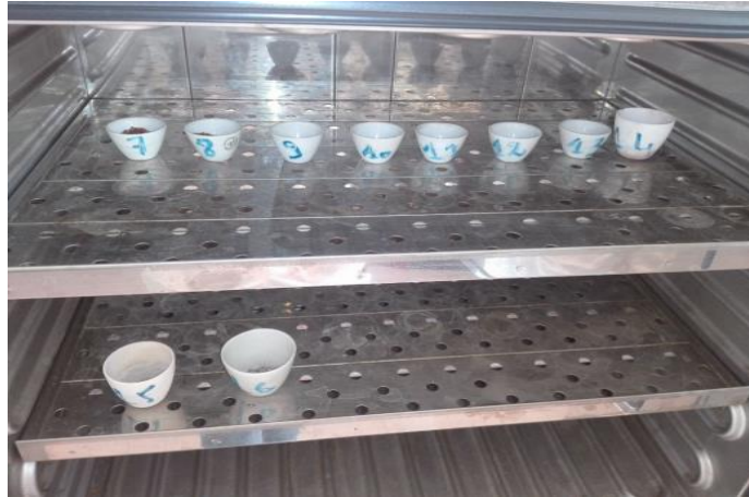
Figure 6: Séchage des échantillons dans l'étuve.
