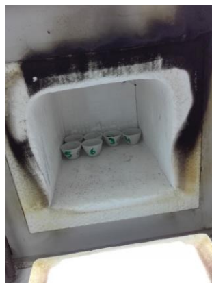
Figure 5 : Incinération des échantillons dans four à moufle.
