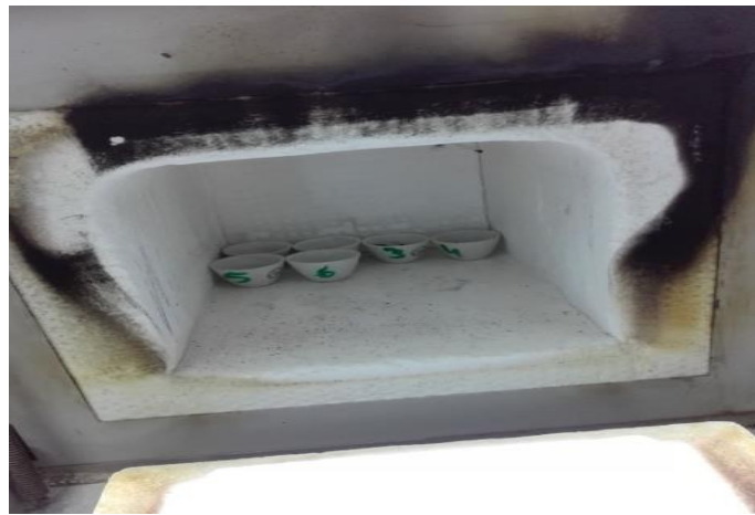
Figure 7: Calcination des échantillons dans le Four à moufle.
