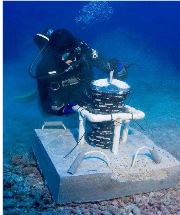
Photo n°4.1 : Mise en place de l'ADCP (Source : Internet).
