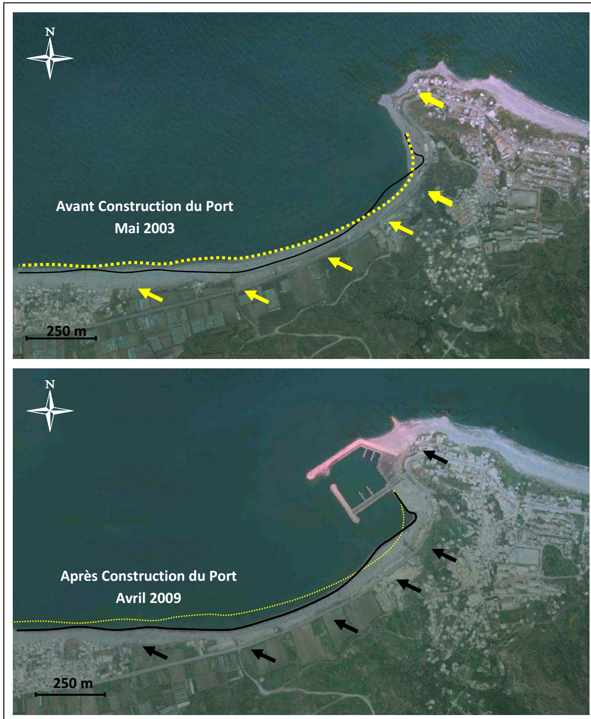
Figure n°1.30 : Configuration de la plage Ouest du port, avant et après sa construction. (Google Earth, Mai 2003 - Avril 2009)
