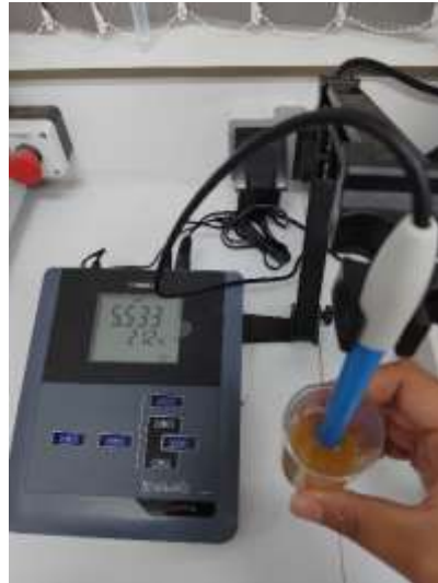
Figure 39 : Mesure du pH du gel nettoyant formulé après ajustement acide — valeur observée : 5,53
