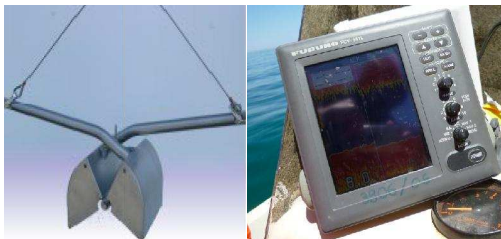
Figure A.2. Une benne «VAN VEEN» et un échosondeur.
