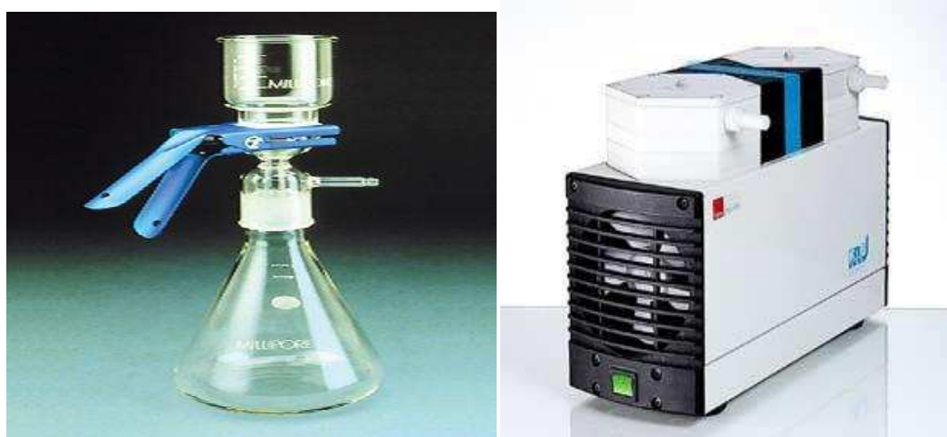
Figure II.3: Pompe à vide et rampe de filtration monoposte.
