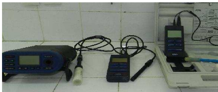
Figure II.2: La valise multi-paramètre pour les mesures in-situ.
