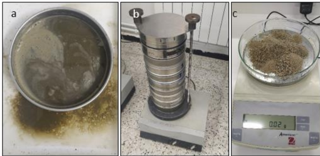
Figure III.6 a. Tamisage sous l'eau ; b. Tamiseuse ; c. Pesage du refus
