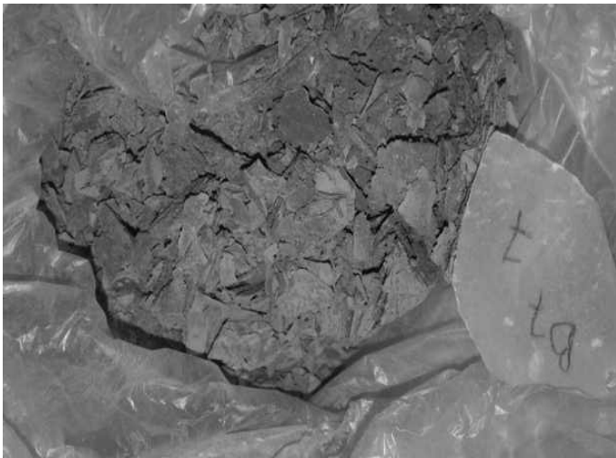
Figure III-10 : L'échantillon de B7 après lyophilisation
