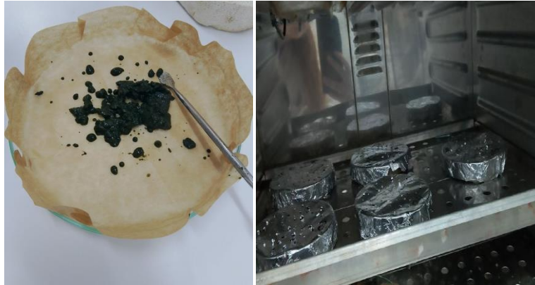
Figure II.18 : Séchage de la patte algale dans l'étuve (Memmert ; 600) à 30°C.
