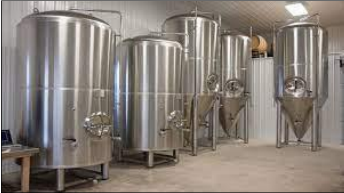
Figure I.11 : Fermenteur de production d'Oméga-3 à partir de micro-algues (FERMENATLG, 2013).
