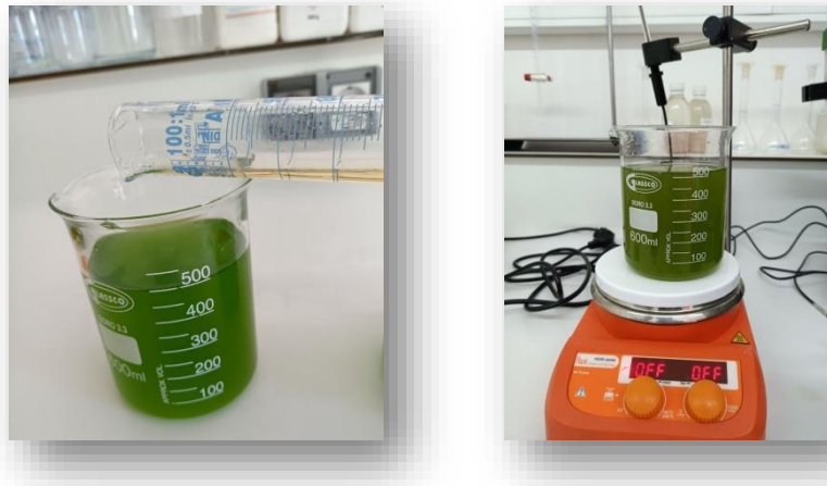
Figure II.15 : L'ajout du flocculant et agitation de la solution par un Agitateur magnétique (Ibx H03D).
