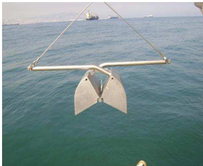
Figure 10 : La benne preneuse Van-Veen .
