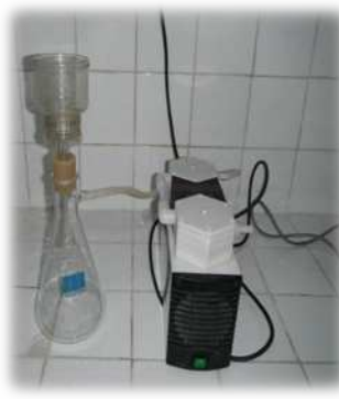
Photo III.7 : Pompe de filtration.
