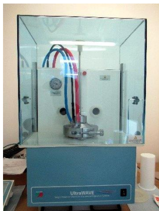
Figure III.8 : Micro-ondes MILESTONE (Chambre de réaction, Ecran d'affichage et Gaz inerte)
