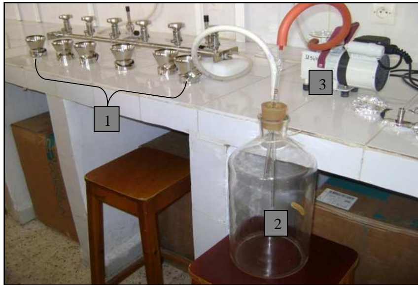
Figure 6 : Dispositif de l'appareil de filtration sur membrane.
