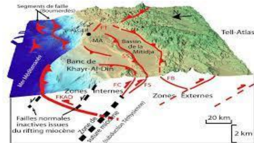
Figure 9 : Interprétation 3D des principales failles Offshore/onshore de la région d'Alger (Extrait de Yelles et al., 2009)
