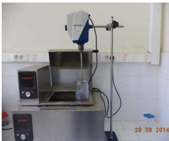
Figure 15 : Bain marie muni d'un agitateur mécanique (déroulement de la déminéralisation).
