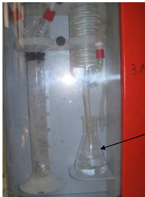
Figure n°8 : L'appareil distillatoire en marche
