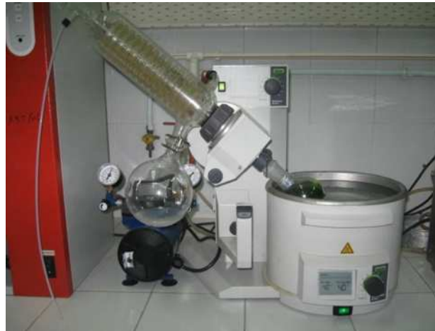
Figure n° 13 : Rotavapor en marche
