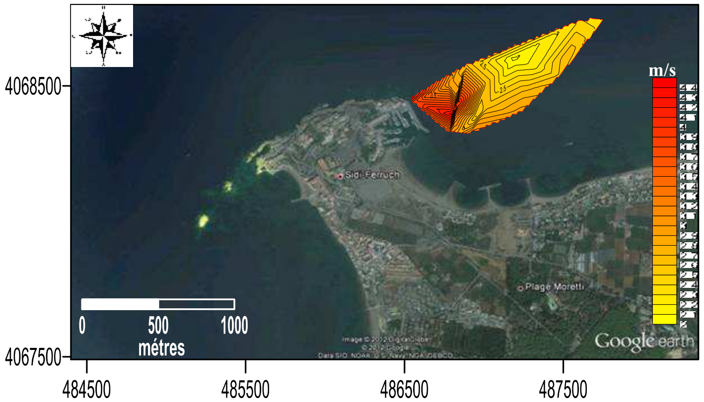
Image III.2 Vitesses orbitales maximales près du fond pour des vagues de Hs: 4,93m NOR- EST 90° et de période de 7s
