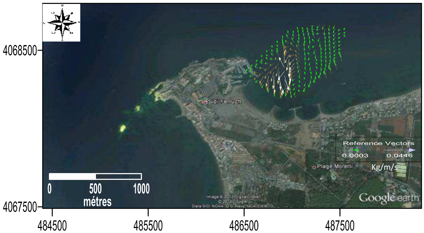
Image III.10 Transport sédimentaire avec vague de retour biennale (amplitude 4.93 NORD-EST 45° période 7s)
