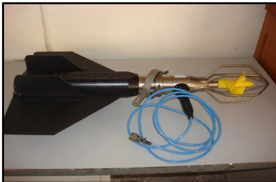
Figure II.3: Les composantes d'un courantomètre 108 MK III
