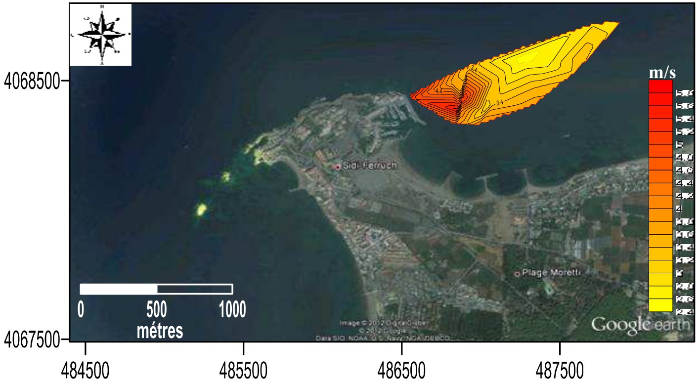
Image III.9: Vitesses orbitales maximales près du fond pour des vagues de H_s : 6,62m, NORD EST 90^\circ et de période de 7s
