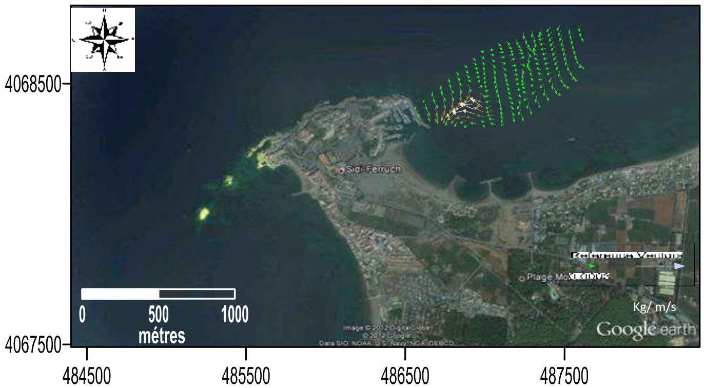
Image III.12. Transport sédimentaire avec vague de retour décennale: (amplitude 6,23m NORD-EST 45°, période 7s)
