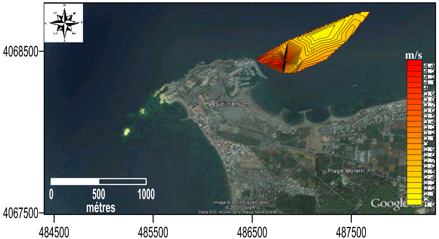
Image III.5 Vitesses orbitales maximales près du fond pour des vagues de Hs: 5,14m EST 90° et de période de 6s
