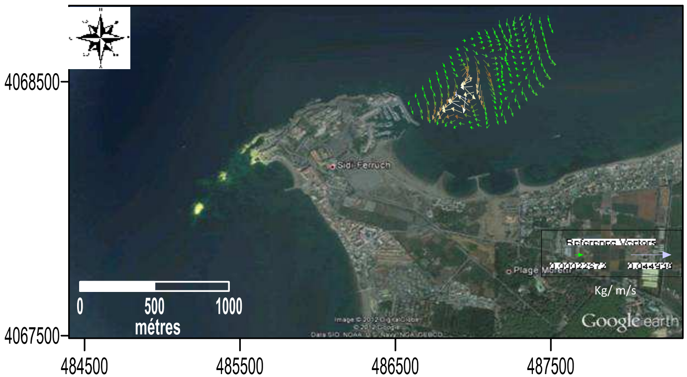
Image III.13 Transport sédimentaire avec vague de retour décennale (amplitude 5,14m EST 90° période 6s)
