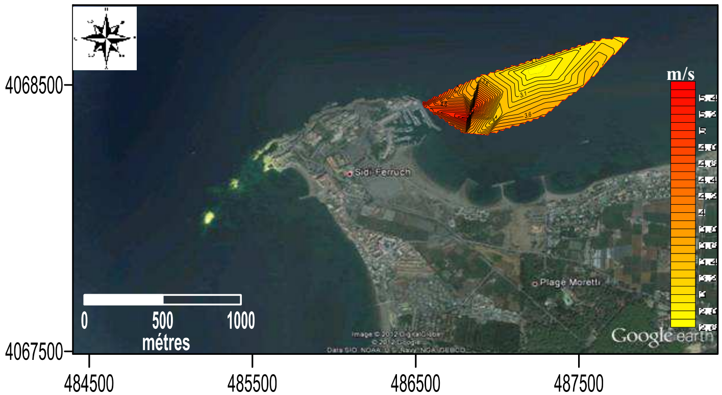
Image III.4 Vitesses orbitales maximales près du fond pour des vagues de H_s : 6,23m NORD-EST 45° et de période de 7s
