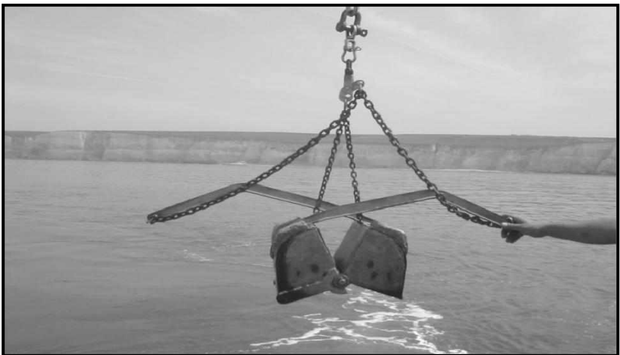
Figure 12: Image d'une benne Van Veen
