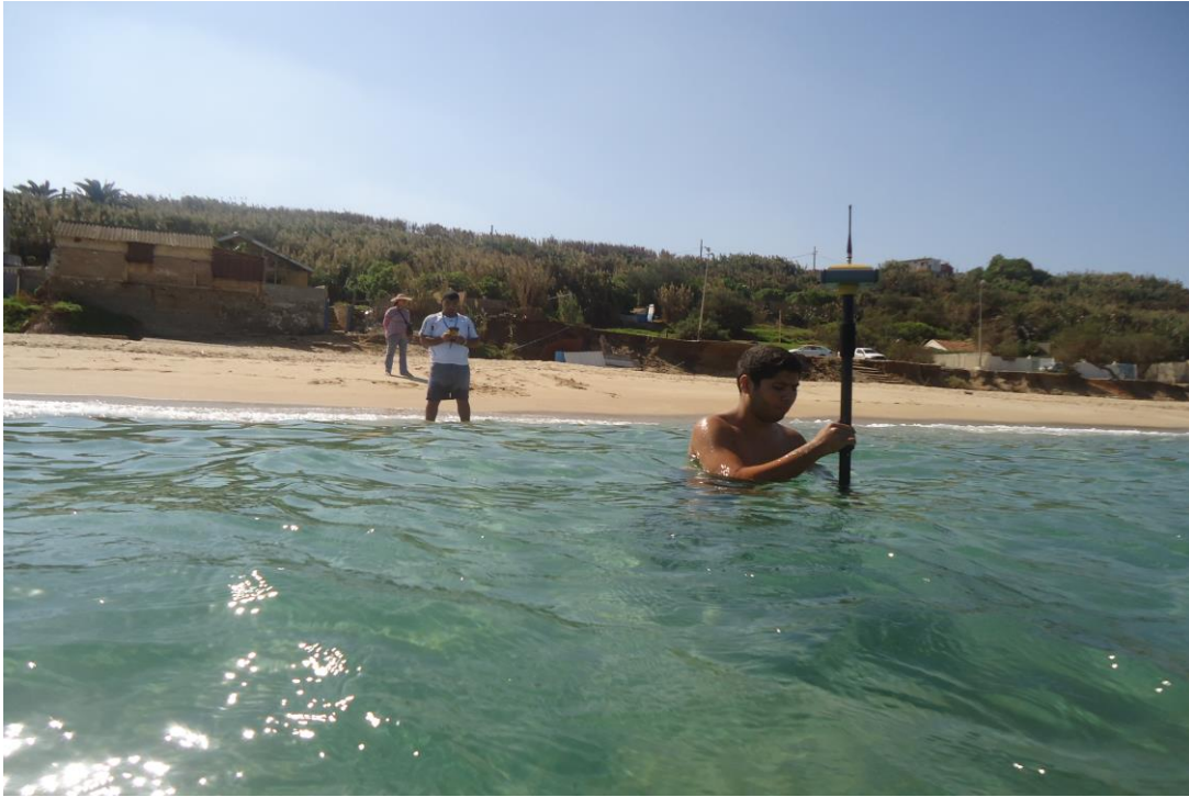
Figure 65 : Mesures topographiques effectuées dans la partie sous-marine (El Kadous, 2014).
