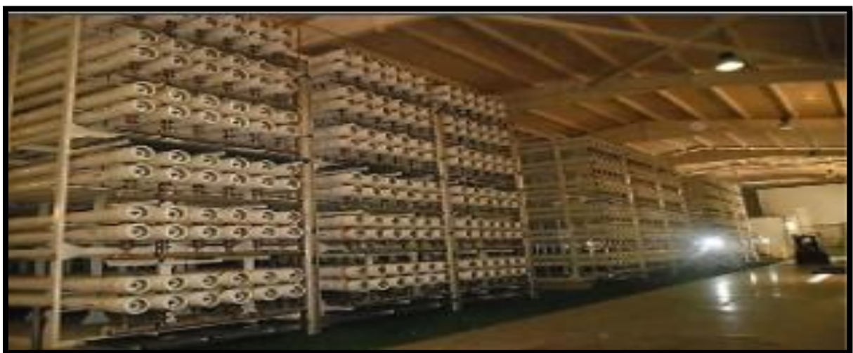
Figure III.17: Les filières d'osmose inverse. (Source : T. sarah,2020)
