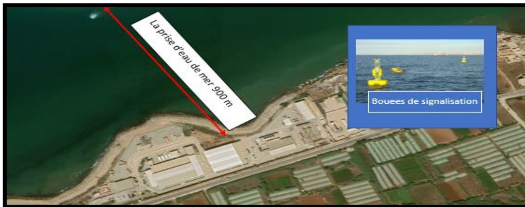
Figure III.13 : La prise d'eau de mer au niveau de la station de dessalement Fouka marine. (Source : L. Dehia, H. Hayet ;2023)
