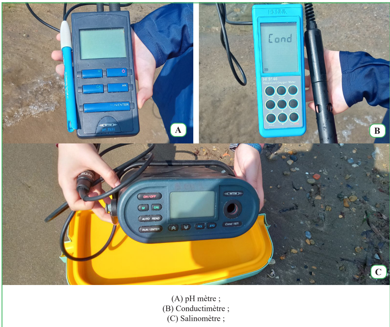
Figure II.6 : Matériel utilisé pour la mesure des paramètres abiotiques au niveau de la plage Ouest de Sidi-Fredj
