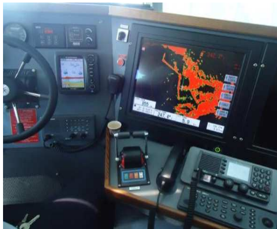
Fig. 51 : Radar et Echosondeur de type Furono de la pilotine Bugia.
