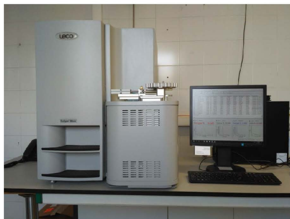
Figure 6 : Leco Truspec CHNS diterminator utilisé pour l'analyse du Soufre total
