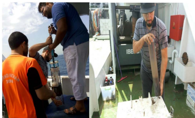
Figure 2 : Prélèvement d'une carotte de sédiment à l'aide du carottier « Uwitec » du CRNA Abord du N/O « Grine Belkacem »
