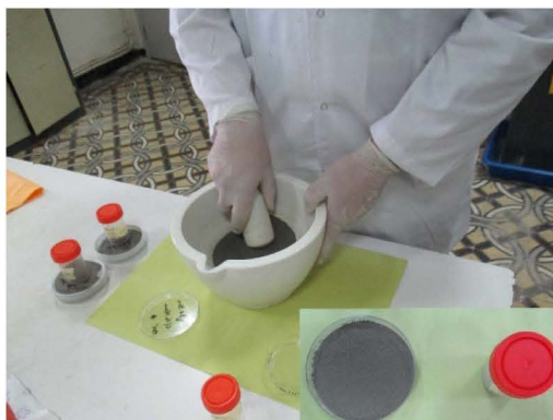
Figure 4 : Broyage et homogénéisation des sédiments avec un mortier en porcelaine Laboratoire « Ecosystèmes Marins et Littoraux », ENSSMAL
