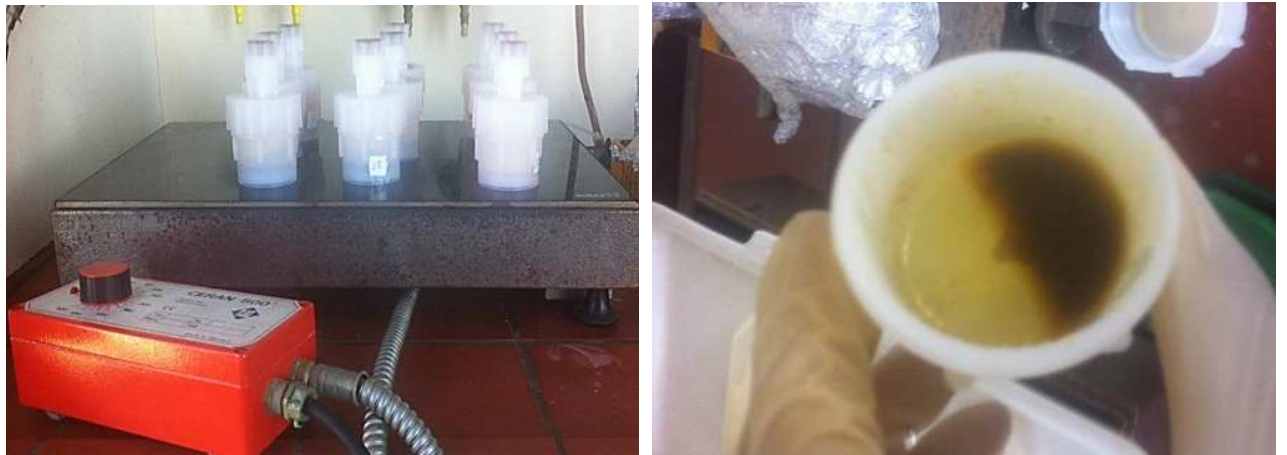
Figure (III.4) : LA Minéralisation sur une plaque chauffante à 120 °C en suivant le protocole de l'IAEA
