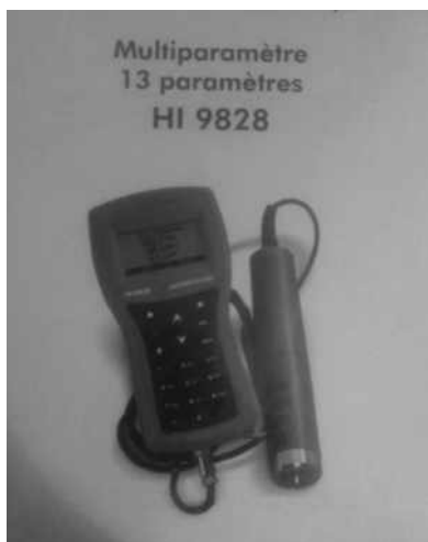
Figure 31: Multi paramètres de type HI 9828 de la gamme HANNA instruments France certifié ISO 9001, Edition 4 du 29/10/2008.
