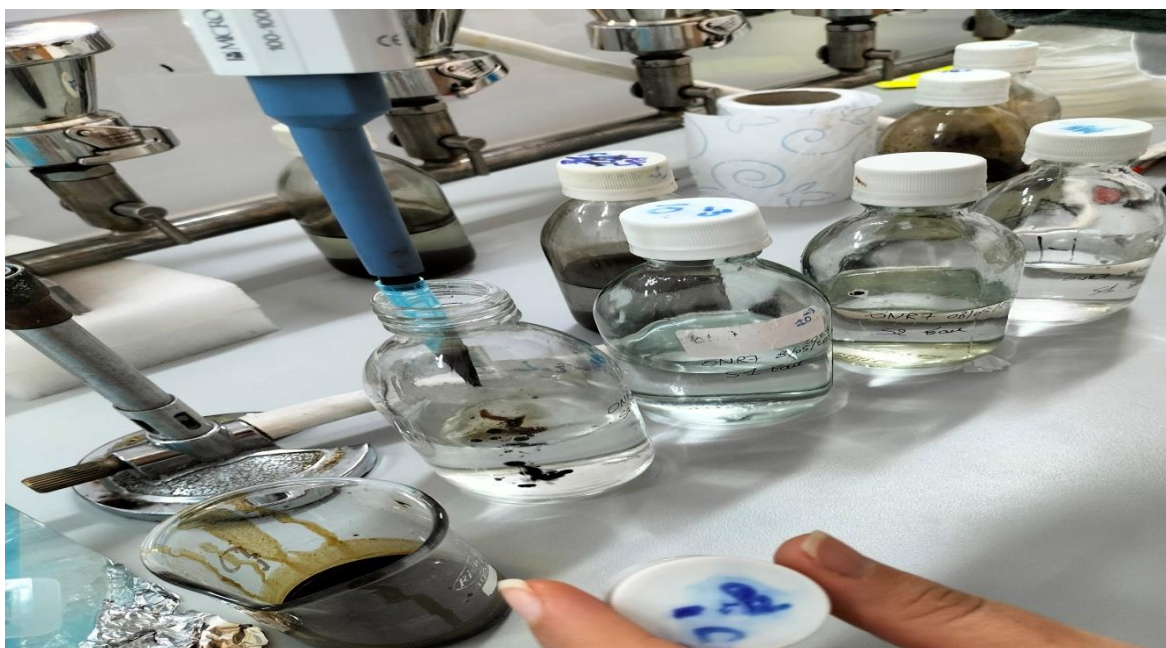
Figure 10. Ajout de pétrole pour l'enrichissement bactérien
