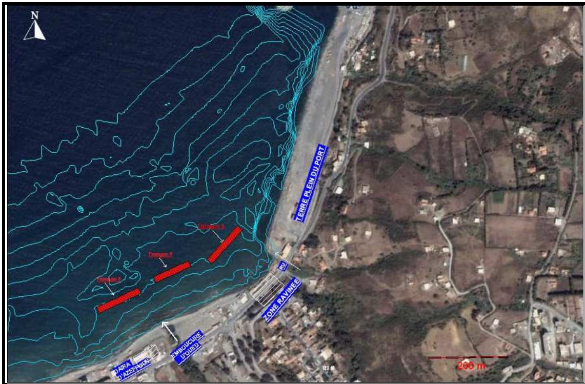
Fig. 37 : Répartition des boudins par tronçons
