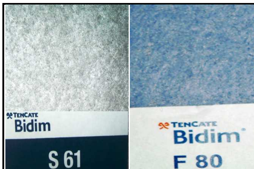
Fig 32 : Géotextiles de types non tissé , S61et F80
