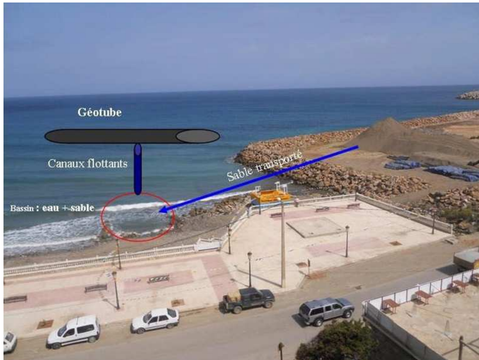
Fig. 44 : Phases d'exécution des travaux
