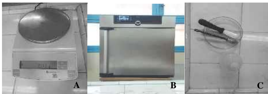
Figure 38: matériel utilisé dans l'analyse granulométrique (A : balance de précision, B : étuve, C : boîte de pétrie-pissette-couteau-pinceau).
