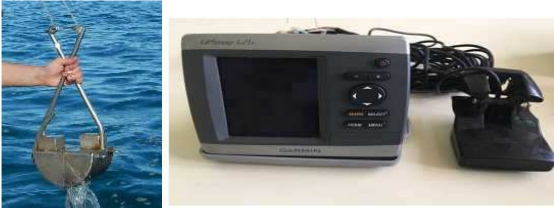
Figure 3: échosondeur gamin 421s et la benne utilisée pour les prélèvements des sédiments.
