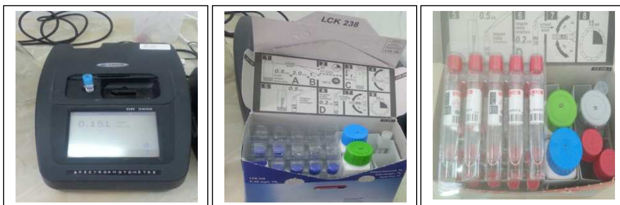
Figure III.19 : Spectrophotomètre Hach DR2800, Kit réactifs LCK238, Kit réactifs LCK338
