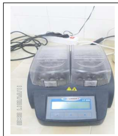
Figure III.17 : Kit réactifs LCK 314, Thermostat.
