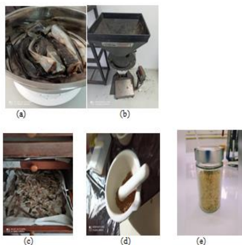
Figure II.3 : Les étapes de fabrication de la farine de poisson (a) cuisson ; (b) pressage ; (c) séchage ; (d) broyage ; (e) stockage.
