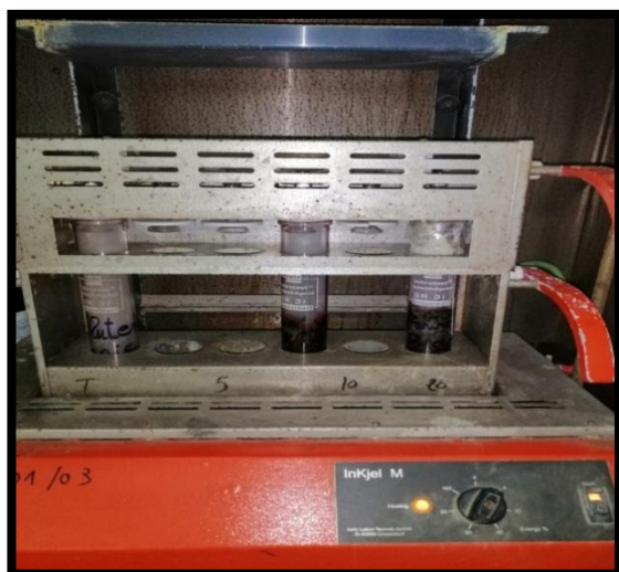
Figure II.5 : Minéralisation des échantillons dans un minéralisateur.
