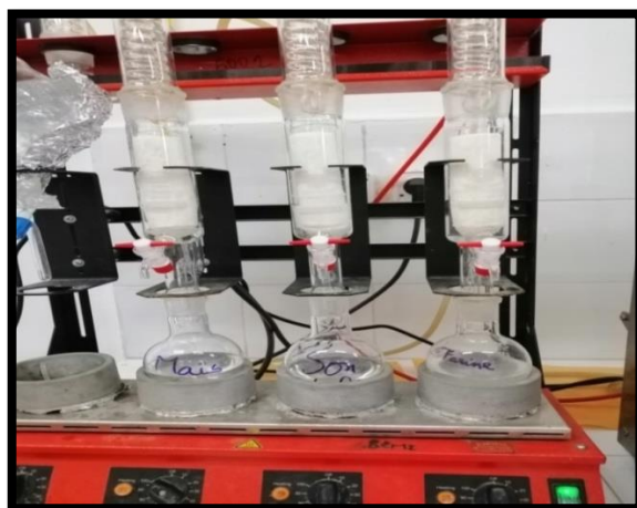
Figure II.8 : Extraction des lipides dans l'appareil de Soxhlet.
