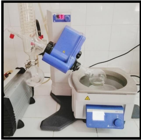
Figure 3: Récupération du solvant
