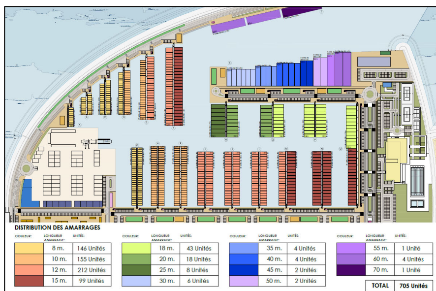
Figure VI-1 : Plan de la marina et distribution des amarrages. (BTP, 2016)
