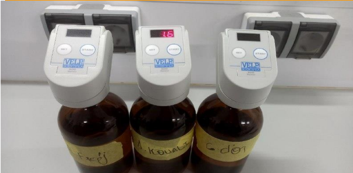
Figure II.20 : le bouchon manométrique (VELP Sensor)
