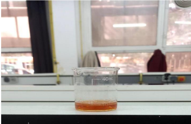
Figure(A2) 6: Test de mise en évidence des polysaccharides méthode de Dubois
