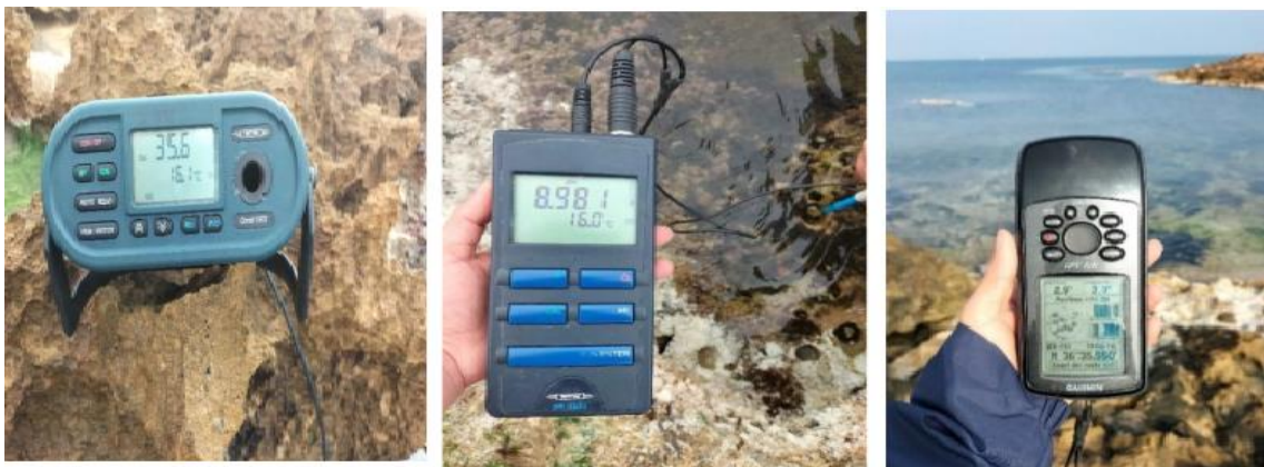
Figure II. 16 : Valise multi-paramètres terrain (pH-mètre, conductimètre) et GPS
