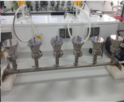
Figure II. 19 : Une rampe de filtration sous vide de marque Sartorius.
