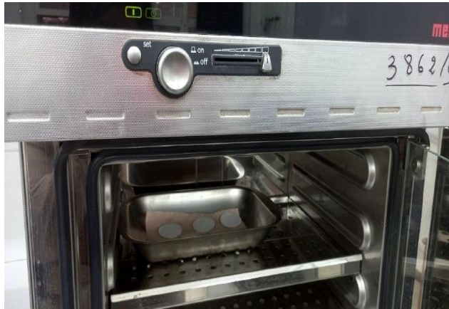
Figure II.18 : séchage des filtres à l'étuve
