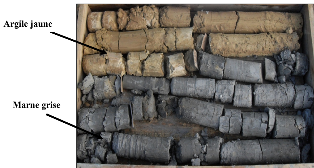
Figure12 : Photo montrant des carottes de marnes grises et d'argile sableuse
