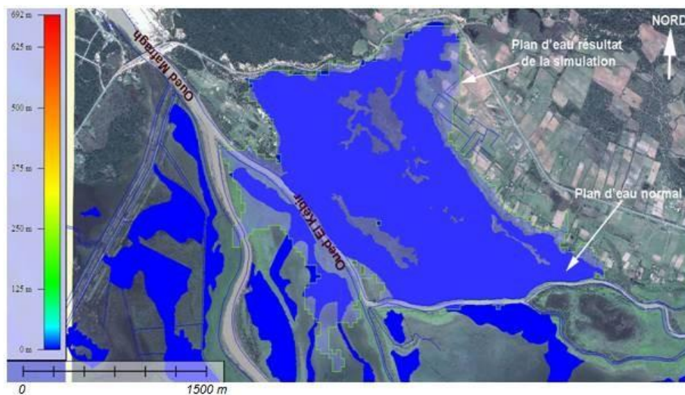
Figure 3. 48 : Simulation d'un débordement de l'Oued El Kébir à l'amont de la Mafragh.
