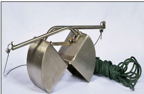
Photo 4.1 : Benne preneuse de type «Van Veen ».
