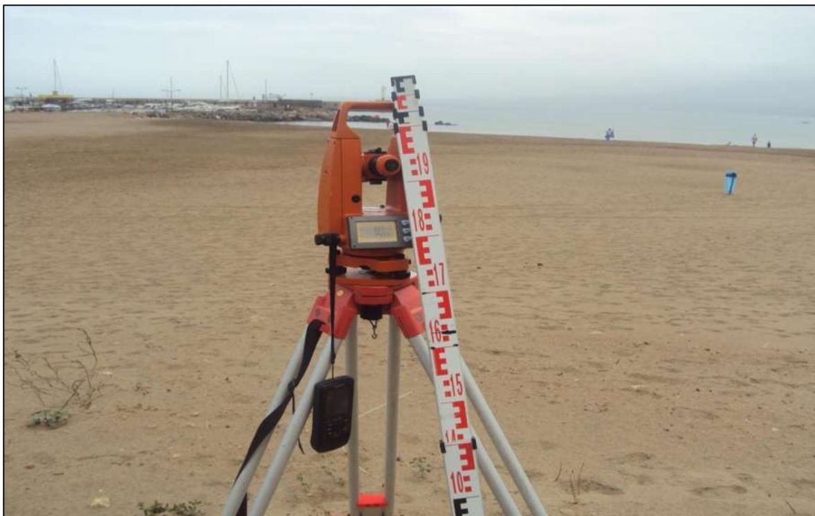
Photo 3.3 : Le matériel utilisé (Théodolite, la mire, GPS)
