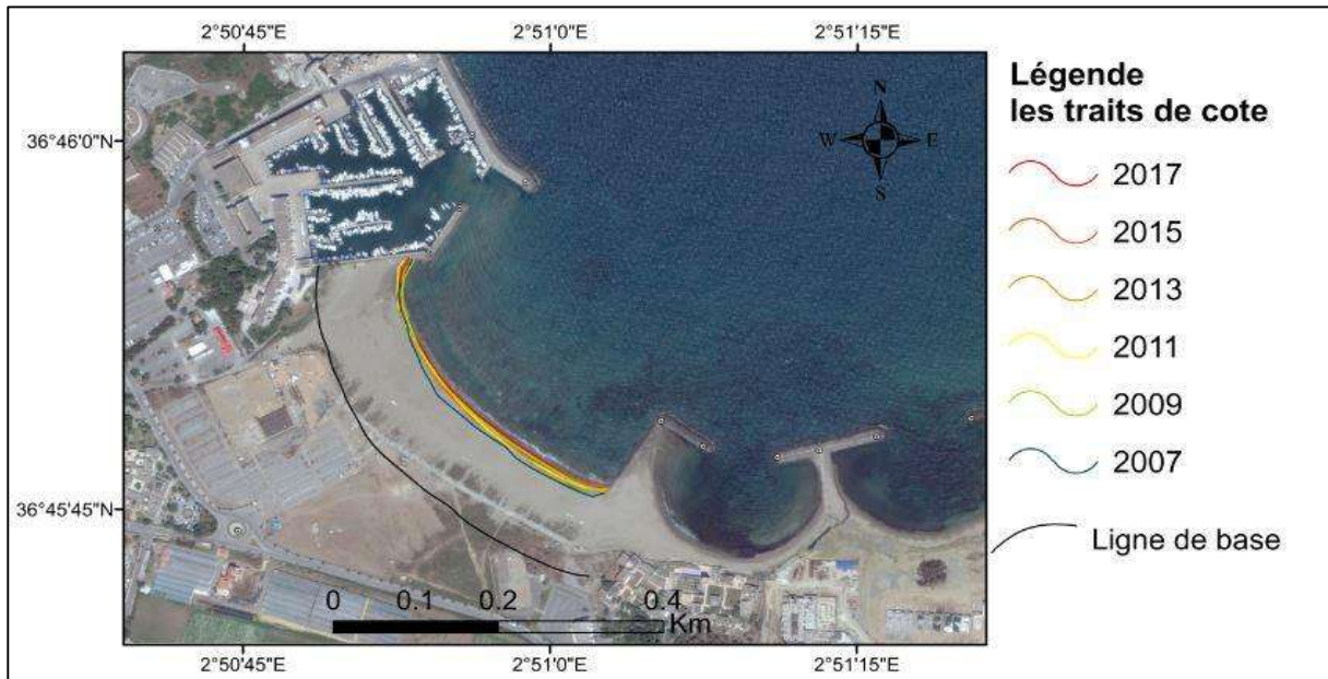
Figure (5.2) : les différentes positions du trait de côte entre 2007 et 2017 par rapport à la ligne de base.
