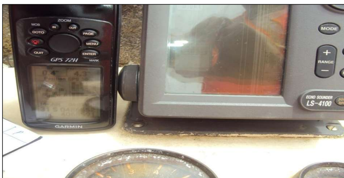
Photo 3.4 : l'échosondeur à droite et le GPS à gauche.
