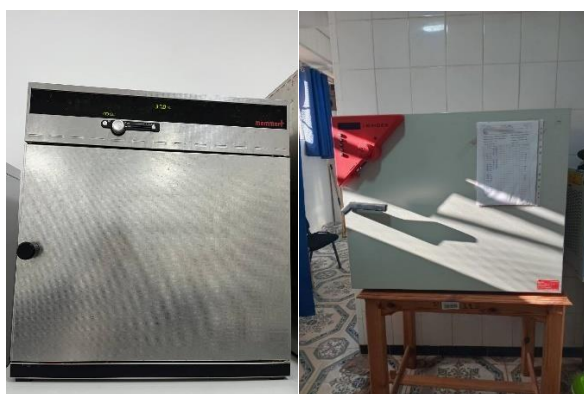
FIGURE 4: ÉTUVE/INCUBATEUR REGLABLE (22°C, 36°C, 44°C)
