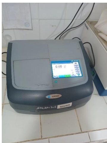
FIGURE 16 : SPECTROPHOTOMETRE UV-VISIBLE : UTILISE POUR LE DOSAGE DES PARAMETRES CHIMIQUES PAR MESURE D'ABSORBANCE A DIFFERENTES LONGUEURS D'ONDE.
