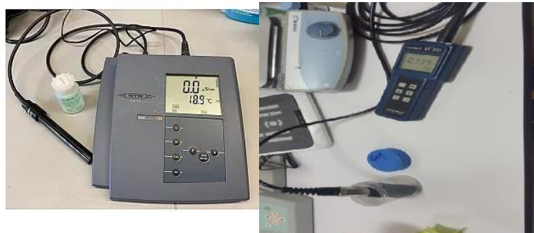
FIGURE 104 : CONDUCTIMETRES HACH SESSION 7 ET WTW ION LAB. 720 UTILISES POUR MESURER LA CONDUCTIVITE ELECTRIQUE DES ECHANTILLONS D'EAU, INDICATEUR DE LA MINERALISATION.
