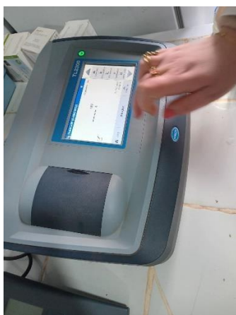
FIGURE 93 : TURBIDIMETRE HACH UTILISE POUR DETERMINER LA TURBIDITE DE L'EAU, EXPRIMEE EN UNITES NTU, REFLETANT LA PRESENCE DE PARTICULES EN SUSPENSION.
