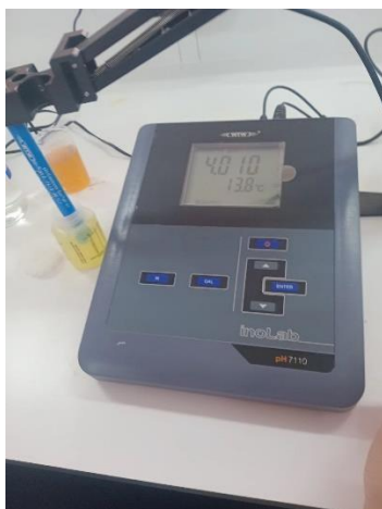
FIGURE 115 : PH-METRE AVEC ELECTRODE COMBINEE : UTILISE POUR MESURER LE PH DES ECHANTILLONS, INDIQUANT LEUR CARACTERE ACIDE OU BASIQUE.
