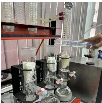
Figure 20: Introduction du solvant dans le système d'extraction
