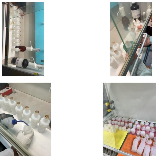
Figure 9; Étapes de préparation et de minéralisation des échantillons.
