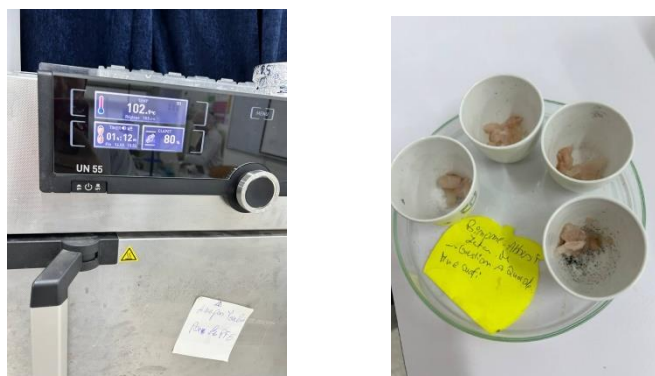
Figure 5: Étapes de détermination de la teneur en eau et matière sèche de la chair de poisson. ( Pesée des échantillons dans les creusets ; Passage à l'étuve à 105 °C).
