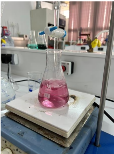
Figure14: Virage de couleur observé après titrage par H 2 SO 4 N/50.
