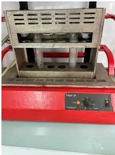
Figure 12: Appareil de digestion Kjeldahl utilisé au laboratoire.
