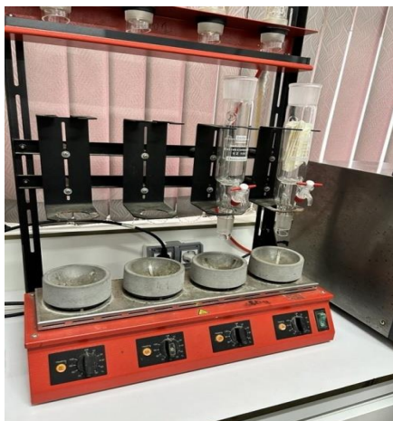
Figure 18: Dispositif d'extraction au Soxhlet utilisé pour l'analyse.
