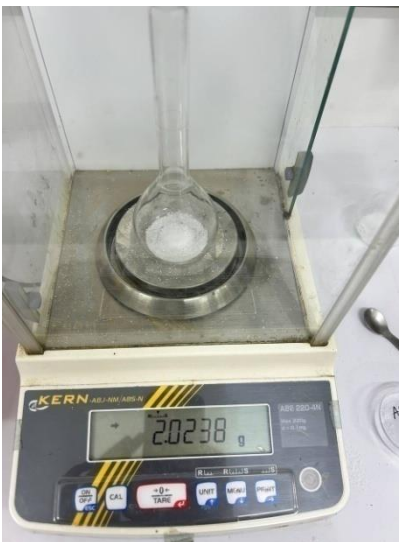
Figure 11: Préparation et pesée de l'échantillon dans le ballon de minéralisation.
