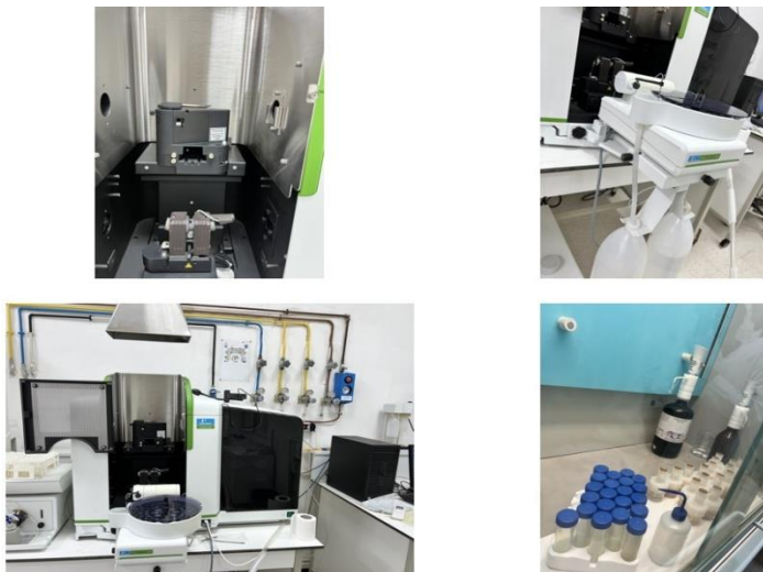
Figure 11: Spectrophotomètre d'absorption atomique et préparation des solutions pour l'analyse.
