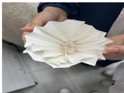
Figure 17: Échantillon placé dans le papier filtre avant extraction.
