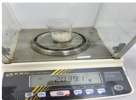
Figure 16: Pesée de la prise d'essai de chair de loup de mer broyée.
