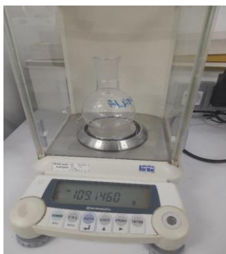
Figure 15: Pesée du ballon vide utilisé pour l'extraction.
