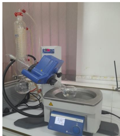
Figure 19: Évaporation du solvant
