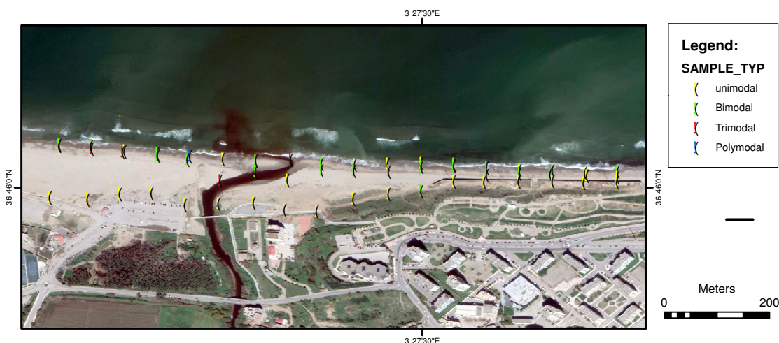
FIGURE 3.9 – Carte de répartition du mode pour chaque station dans la plage Corso.
