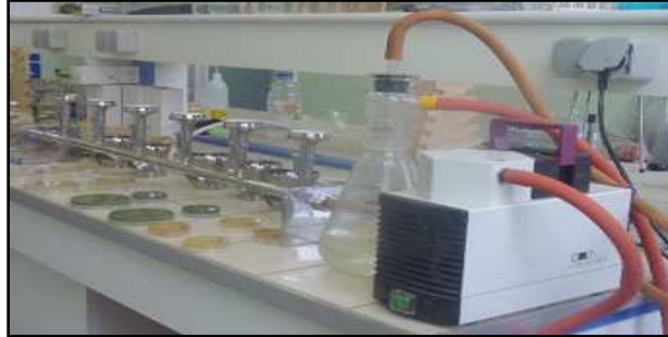
Figure II.4. Dispositif de l'appareil de filtration sur membrane
