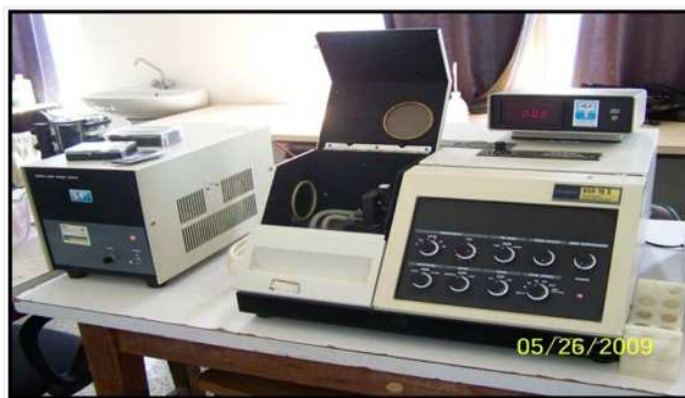
Figure II.11. Spectrophotomètre de Fluorescence HITACHI, modèle 650 S, équipé d'une lampe « Xénon ».
