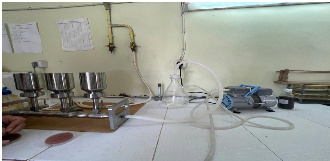
Figure 15 : Rampe de filtration (présente étude)
