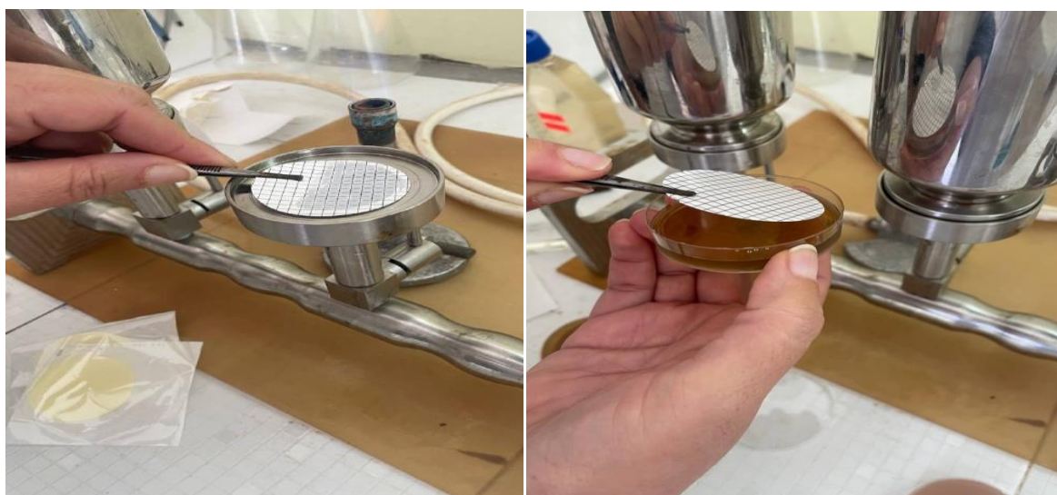
Figure16: Les étapes de filtration sur membrane.(présente étude)
