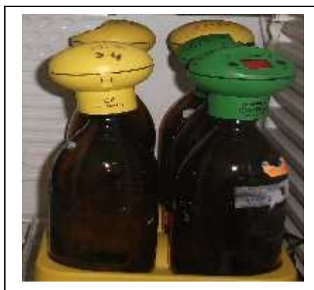
Figure(III.5) : flacons en verre fumée pour la DBO_5 .
